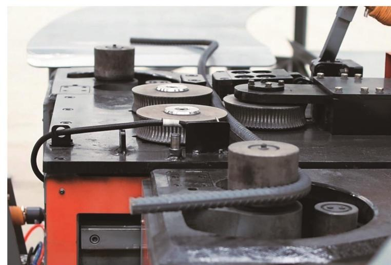
加工钢筋直径:  $\Phi 10\text{mm}-\Phi 32\text{mm}$
