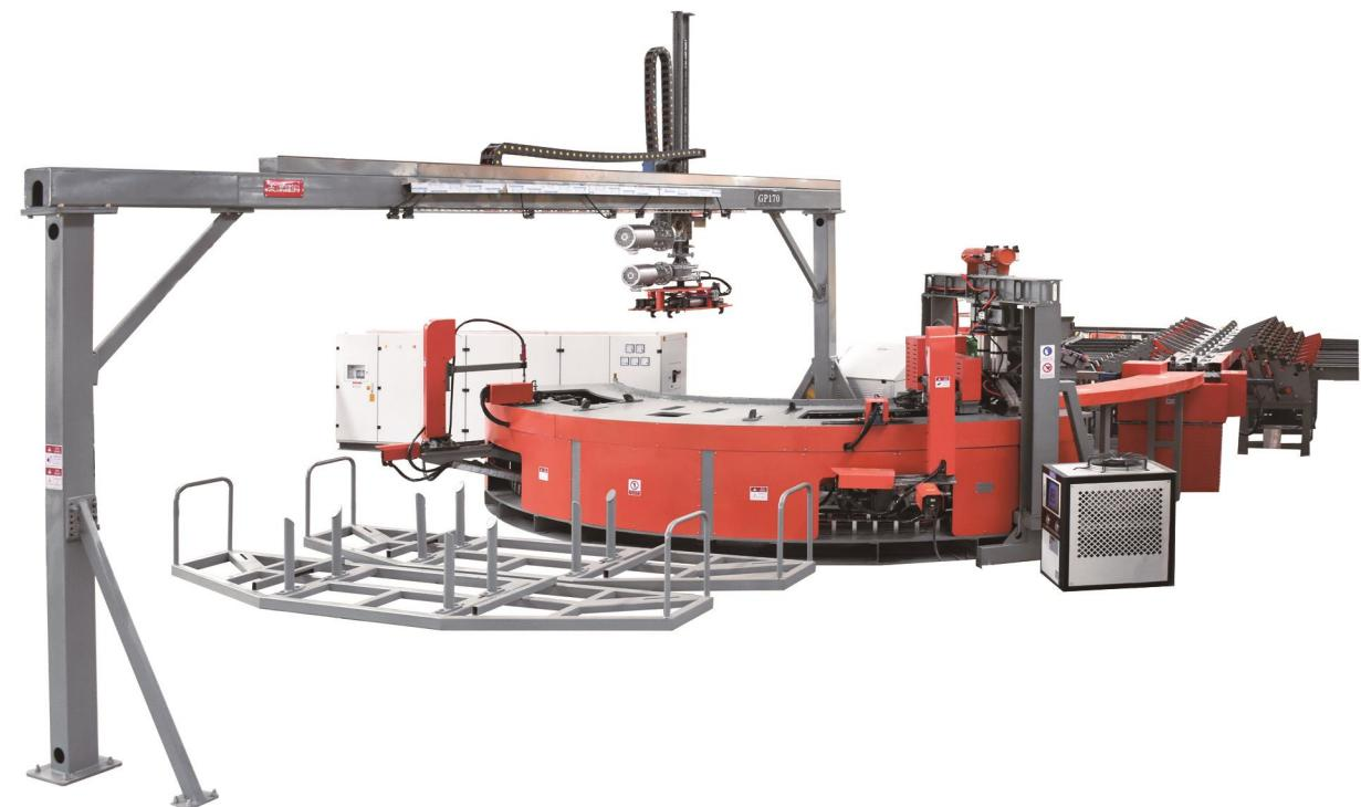
GPPMW170盾构管片平面网成型机主要由弯弧装置、弧度定型装置、横筋焊接装置、牵引装置、移动夹紧机构、固定夹紧机构、弯曲检测装置、焊接机械手等组成。通过高精度三坐标焊接机械手进行主筋的搭接焊接，采用伺服定位横筋位置、自动落横筋和电阻焊的方式进行横筋与主筋的焊接。
