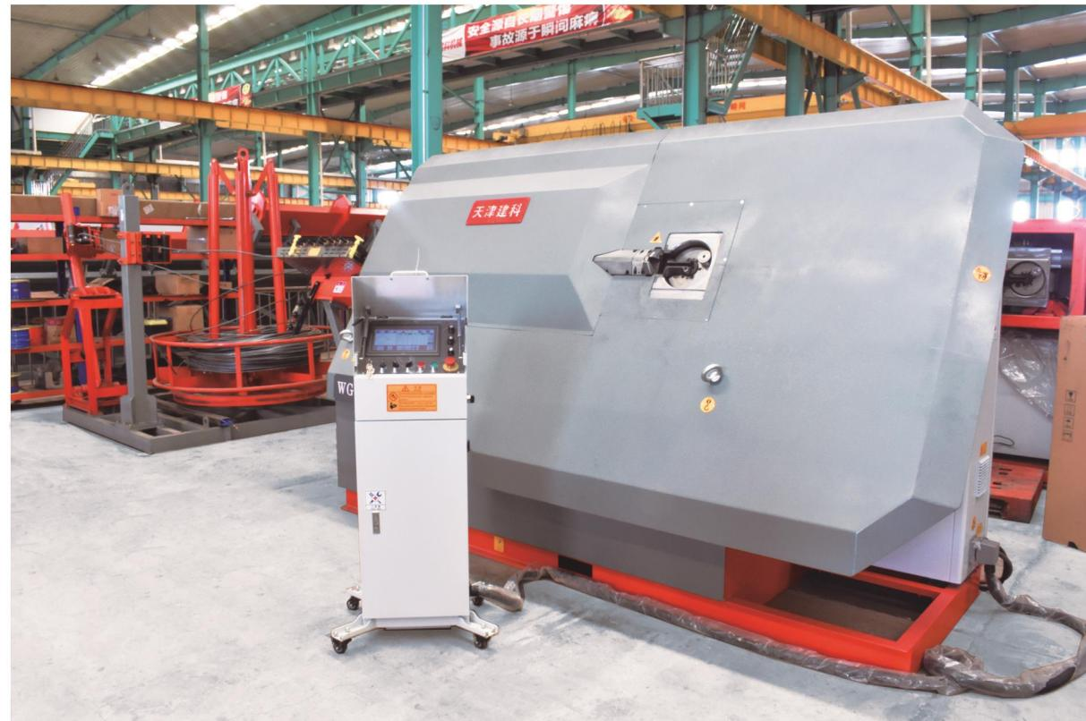
WG12E-2数控钢筋弯箍机采用气动型高效的双工位多功能弯曲机构，生产速度提高20%，可高效的完成各种特殊形状的弯曲，弯曲圆弧角为R6-R35（中心销直径Φ12-Φ70）。大型斜面设计，加工范围大，可加工1670mm以内的各种箍筋，也可加工小至70X70(mm)的小箍筋。
