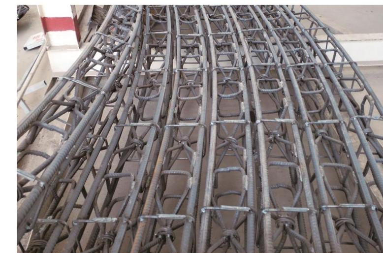
主筋直径：Φ20mm-Φ25mm
