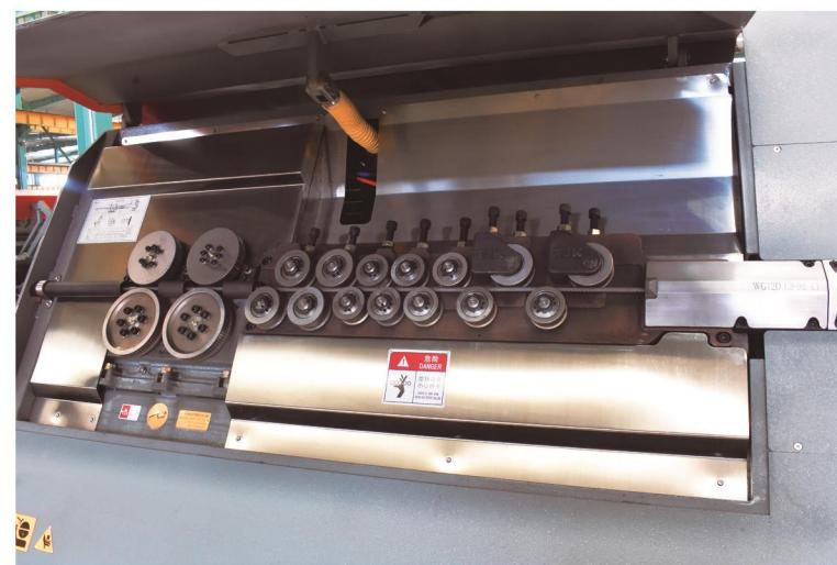
单钢筋加工直径：Φ5mm-Φ13mm
