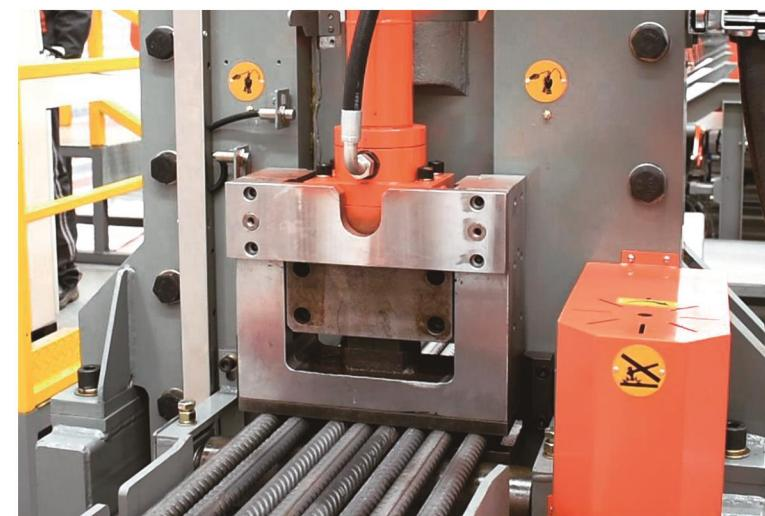
加工钢筋直径：Φ10mm-Φ50mm
