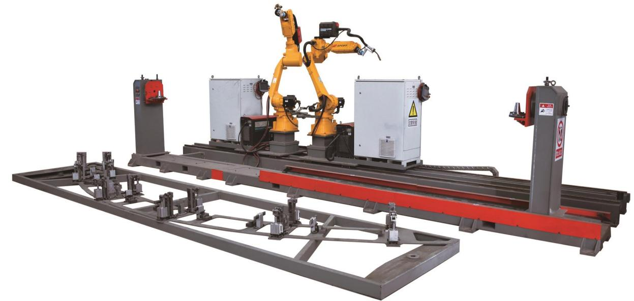
GS1800-6格栅焊接平台由两台在同一轨道上的焊接机器人以及变位机组成，焊接机器人配置激光智能检测装置，主要完成格栅各焊接点的焊接工作。生产流程为人工将蝴蝶筋、主筋放入专用模具，通过龙门和辊道完成线上流转，完成格栅焊接生产。
