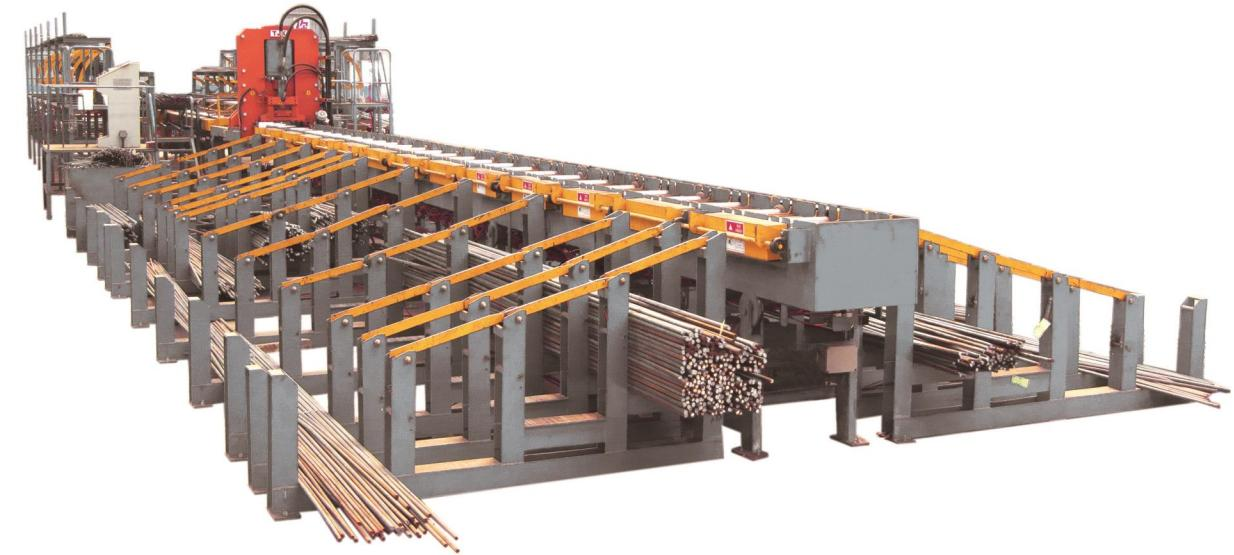
GJW150B数控钢筋液压剪切生产线能够实现对800-12000mm棒材钢筋的定尺剪切需求。定尺机构设有不同长度的定尺挡板，由伺服控制系统调节，可精确控制剪切长度。剪切机构防跳动自动压紧装置不会出现钢筋滑动现象。该生产线配合平面网成型机，实现剪切成品、半成品的轨道化传输。
