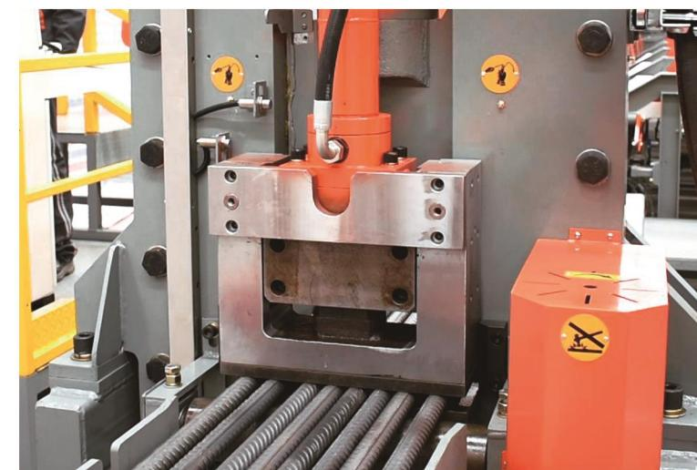
加工钢筋直径：Φ10mm-Φ50mm
