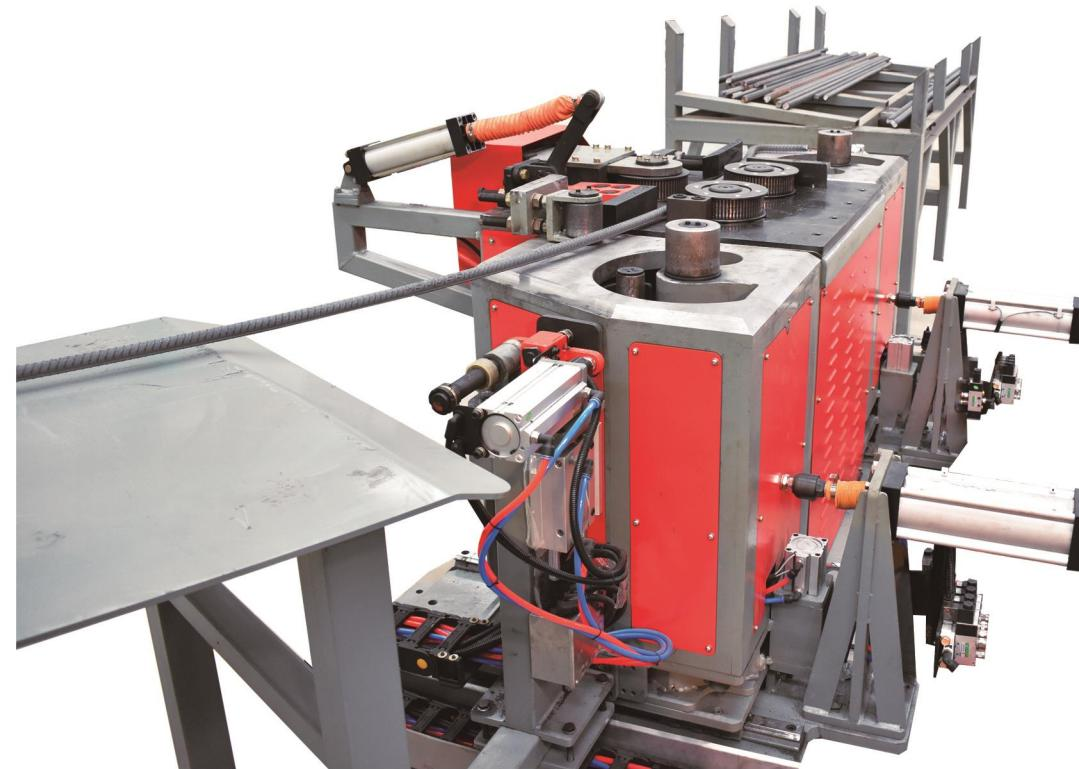
WHWQ32数控钢筋弯弧弯曲机主要用于管片钢筋笼中内弧筋和外弧筋的加工，可直接将一根直条钢筋弯弧弯钩一次成型，降低了工人的劳动强度。
