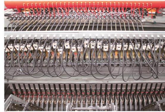
焊接主机采用倍力增压气缸（体积小、压力大），每个气缸都安有独立的可调节流阀，用以调整压缩空气的流量，保证了焊接气缸的一致性，以及气缸压下的速度，避免过分冲击。
