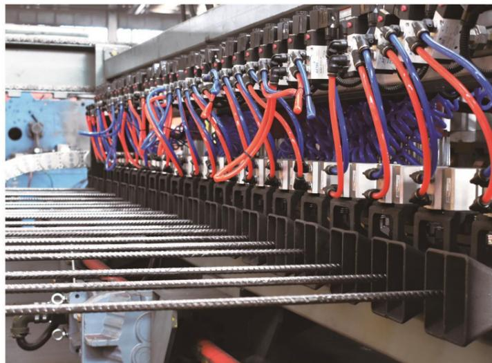
纵筋直径： $\Phi 5\text{mm}-\Phi 12\text{mm}$ （直条）
