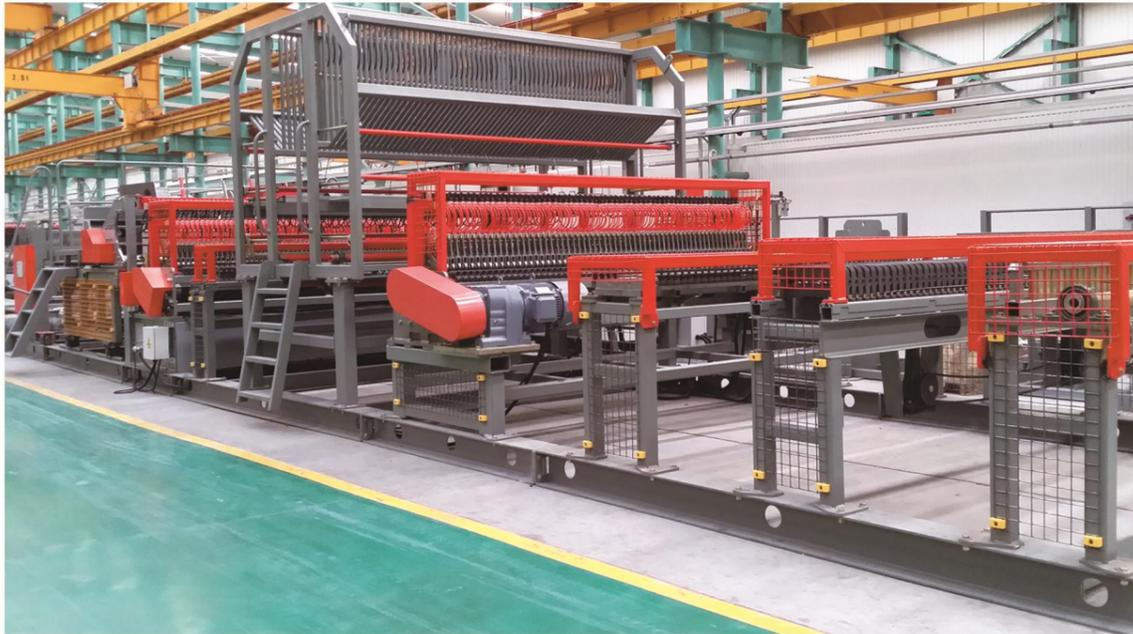
GWCZ/P2400WL-B数控钢筋网片焊接生产线分为直条和盘条两种类型,可将直径3-6mm的冷拔钢丝、镀锌铁丝、带肋钢筋焊接成最大宽度2400mm的网片。为了达到设备的最大稳定性及使用性,所有传动加工件均采用耐磨,优质材料,使其寿命大大提高。人性化操作,在设备的各个机构都有独立的电控系统,操作人员能在设备的任何机构启动设备运行;丰富的人机互动画面,可直接反馈出故障点,减少操作人员查找故障时间。
