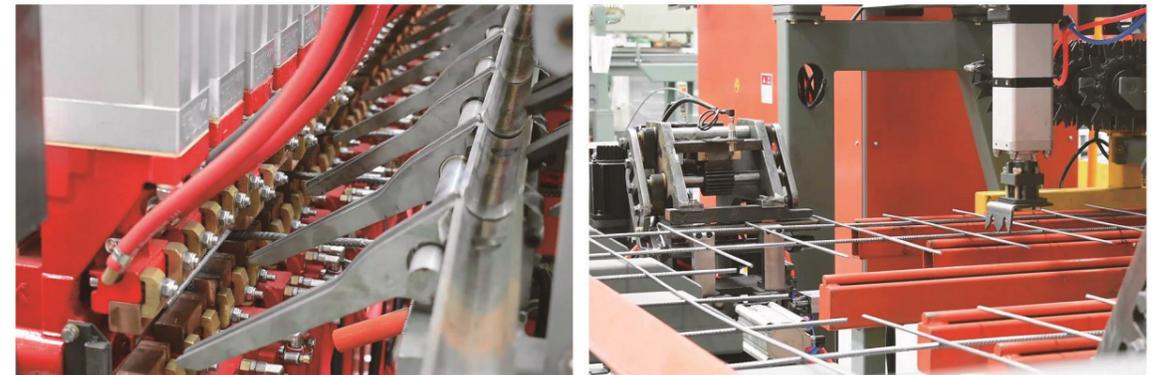
网片宽度：1200-3200mm 纵筋直径：Φ5mm-Φ12mm（盘条）
