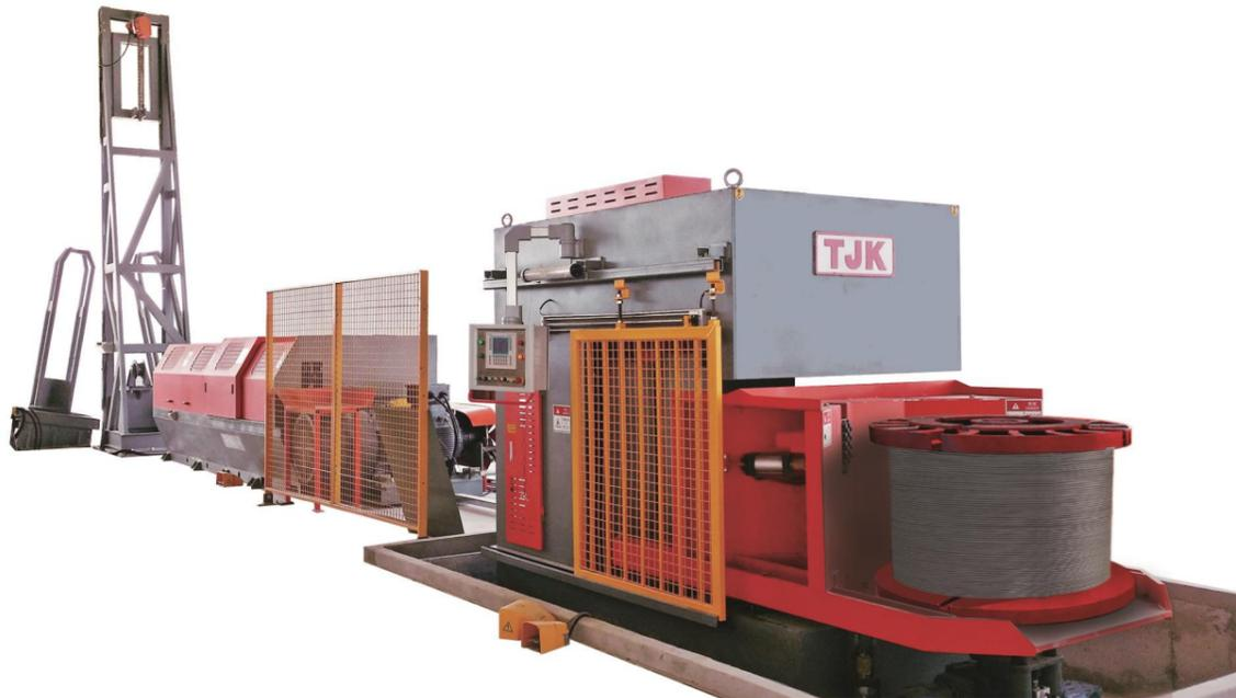
LZ-GZBL12GL2-12数控冷轧带肋钢筋生产线大量应用于铁路、基建，并配套焊网机、三角梁使用，冷轧成品钢筋直径12mm-5mm，设备最高速度12m/s，产能强大。主机采用一体机形式，占地空间小，安装方便。主机封闭式设计，自动化卫生环保。各部分核心机构均采用德国技术，技术水平国际领先。拉拔机采用两档变速拉拔，充分发挥电机功率，大大的提高了设备产能，降低能耗。收线机采用立式双工字轮全自动收线，实现自动抓取钢筋、自动剪切、自动固定钢筋于一体，工字轮自动切换仅需15s时间，安全与效率共赢。
