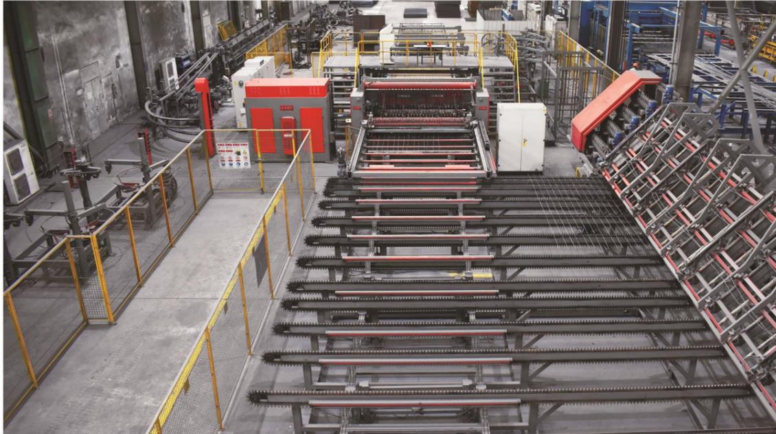
HW-WZD12数控钢筋网焊接生产线采用横筋、纵筋全为盘条上料的方式，可焊接最大网片宽度2800mm，焊接速度可达50-80根横筋每分钟。设备的横筋、纵筋上料机构内部分被配置4组矫直模块，分别对应四种不同丝径的钢筋，在使用过程中可根据订单网片规格的需要自动切换；横筋可分别从纵筋的上方、下方输送，焊接成型的网片不需要进行翻转后码放。拉网机构可一次性将十二米长以内的网片拉出，拉出后的网片经过升降接网机构码放，高效率生产。
