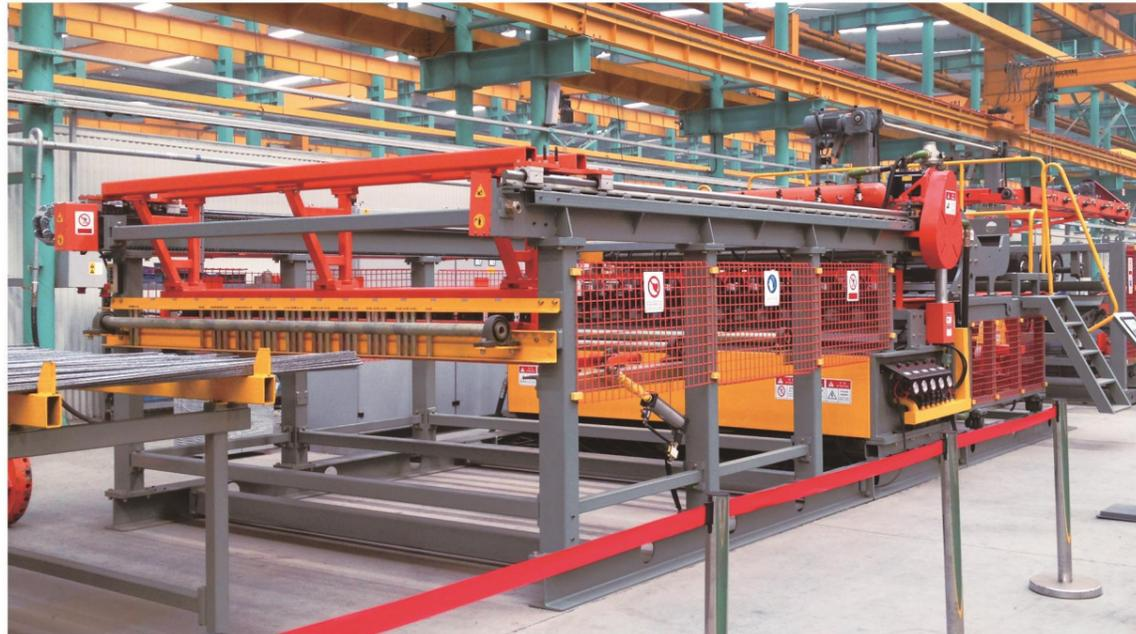
GWCZ3300JZ-F数控钢筋网焊接生产线是主要用于焊接高速铁路，建筑、公路、铁路、核电、基建等用途的网片的焊接设备，该设备可焊接宽度 $\leq 3300\text{mm}$ 网片，纵筋间距 $\geq 100\text{mm}$ 可自由调节；既可以焊接标准网片又可以焊接开孔网片。纵筋开孔部分采用在线自动剪切装置，实现全伺服控制自动送进与切断。落料采用上、下双层二套落料装置分别落一根长线和二根短线，全自动化的落料结构，将成捆的钢筋放置上去之后不需要人工助，实现自动落料。
