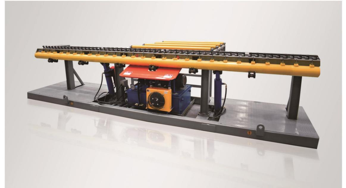
MB6000液压钢筋弯网机是适用于当今建筑行业快速发展的需求而设计制造的。按结构与功能可以分为：弯曲主机、液压站、控制系统、电控柜。可根据用户的不同需求弯出0°~180°之间的任何一个角度，只需操作人员调整好所弯网片角度，以及该角度所对应的气缸上磁力开关的位置即可。
