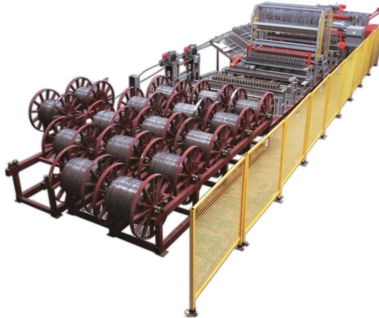
GWSP2400WL-B数控钢筋网片焊接生产线可焊接宽度 $\leq 2400\text{mm}$ 网片，并可对任意线材进行交叉焊接。纵丝、横丝均为盘条上料，原材可为 $\phi 3.0\text{mm}$ - $6.0\text{mm}$ 的冷拔钢丝、镀锌铁丝、带肋钢筋。该设备采用数控伺服控制系统，精度准确，效率高；为了达到设备的最大稳定性及使用性，所有传动加工件均采用耐磨，优质材料，使其寿命大大提高。
