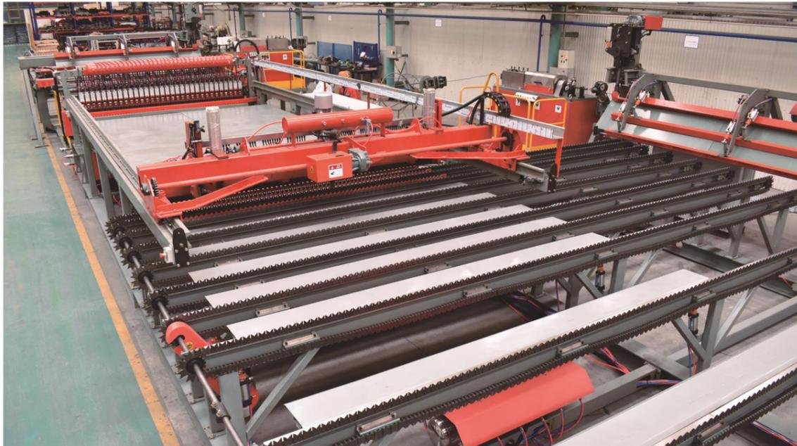
GWCAK3300-1数控钢筋开孔网焊接生产线为满足客户的使用性能特开发CAD图纸解析软件，可将CAD图纸转换成DXF格式并完整解析图纸数据。生产线可将盘圆钢筋全自动调直、剪切、焊接、成型；无缝切换多规格钢筋网片边角料、开孔无需按照标准网尺寸进行高成本的剪裁；焊接网片图形由CAD图形输入，无缝、快速变换网片规格。
