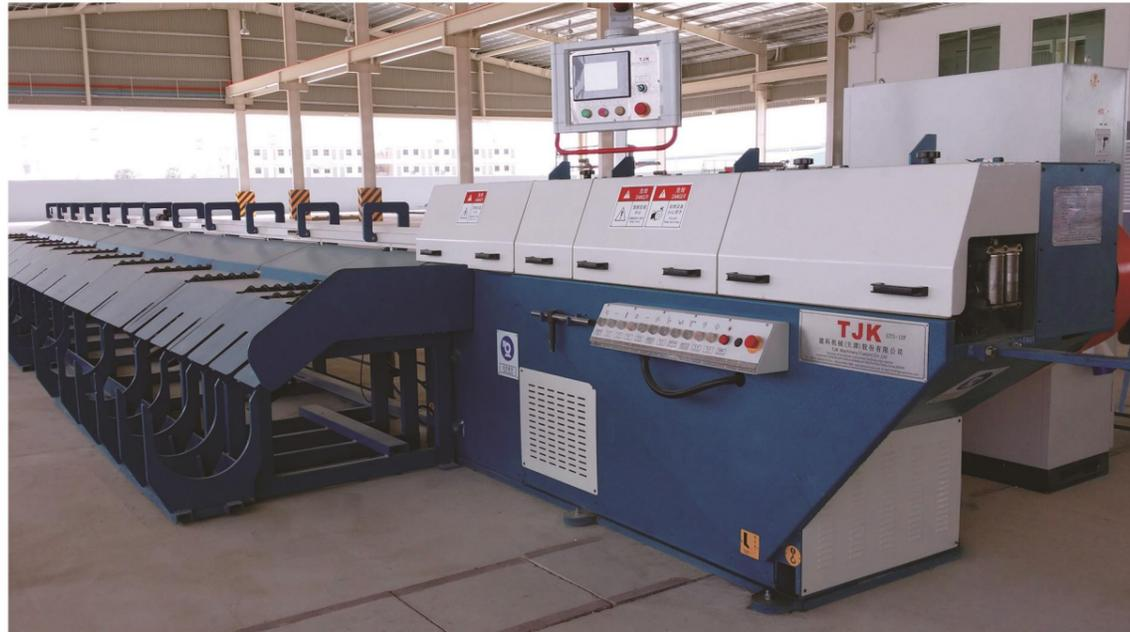
GT5-12数控钢筋调直切断机采用旋转矫直方式，钢筋直线度高。主机可进行三档速度调节，以适应调直不同直径、屈服强度钢筋的速度要求。配有自动对齐装置，出料整齐，便于大批量生产。该设备可加工CRB600H的冷轧带肋高延性钢筋，对于规模较大的钢材经销商、钢筋焊网厂、钢筋直条厂、钢筋配送中心等企业尤为适用。
