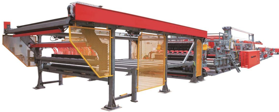
GWCZ3300JZ-C数控钢筋网焊接生产线是一台横筋纵筋全为直条上料的焊网设备，可焊接最大网片宽度3300mm，焊接速度可达60-90根横筋每分钟。能够根据输入的网片参数自动选择恰当的模块并自动调整间距。尤其适应钢筋加工配送企业，能很好的解决钢筋网小批量，多规格连续生产。焊接主机采用32套独立的焊接单元，每个焊接单元配备有一台63KVA变压器和独立焊接系统，单点单控，焊接稳定，焊点质量高。
